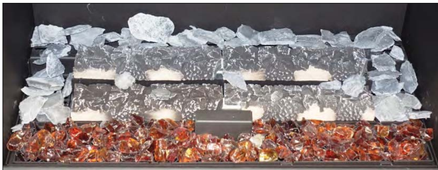
5. Plaats de houtskoolstukken op de aangegeven plaatsen rondom het branderbed. Zie 2.6 voor de nummers van de onderdelen.
