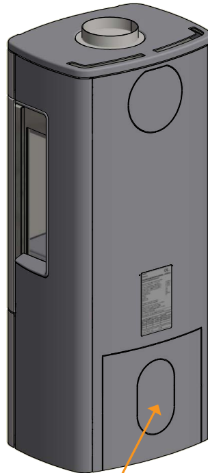
Afdekplaat moet verwijderd worden
