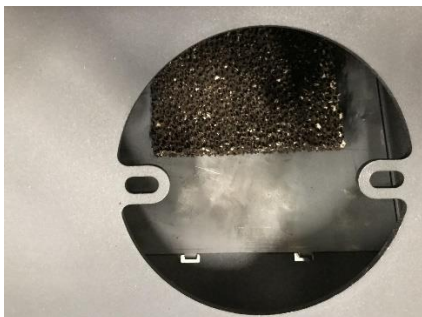
Montage van katalysator gezien vanaf de rookadapter boven het vermiculiet-rookschot
