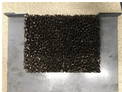
Montage van katalysator gezien vanaf de rookadapter boven het vermiculiet-rookschot
