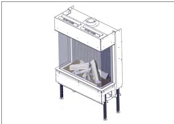
Figuur 24. Uitlijnen met behulp van de stelvoeten
