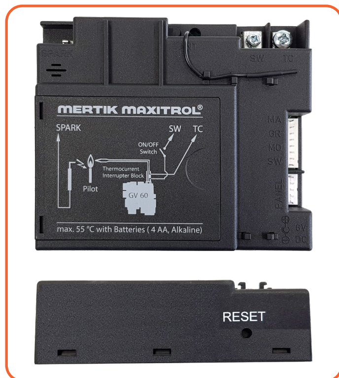
Afb. 4.3 Zij- en bovenaanzicht ontvanger
